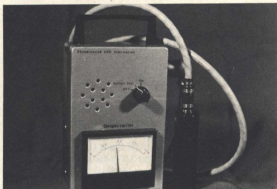
SUFOIs transportable geigertæller. Til højre i billedet ses det rør, der anvendes til måling af gamma-stråling.
